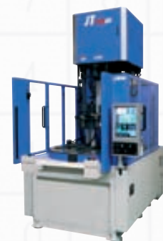
J70RAD-110V Drehtischdurchmesser 1160 mm Schussgewicht 10 bis 130 g
